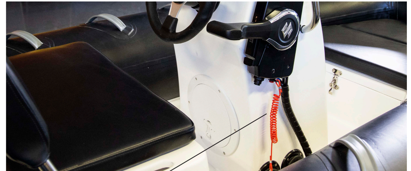
Fig. 13. Ledning til dødmannsknapp.
